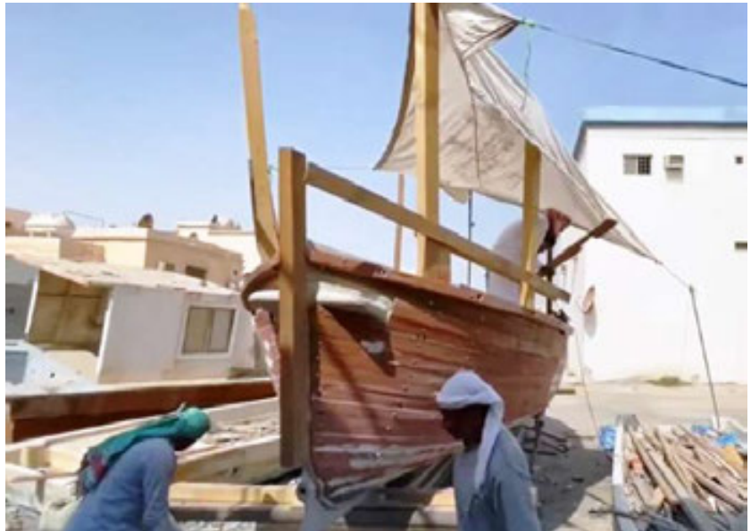
يحتاج القلاف إلى حس فني لمعرفة سماكة الخشب وانحنائه المناسب لكل جزء
